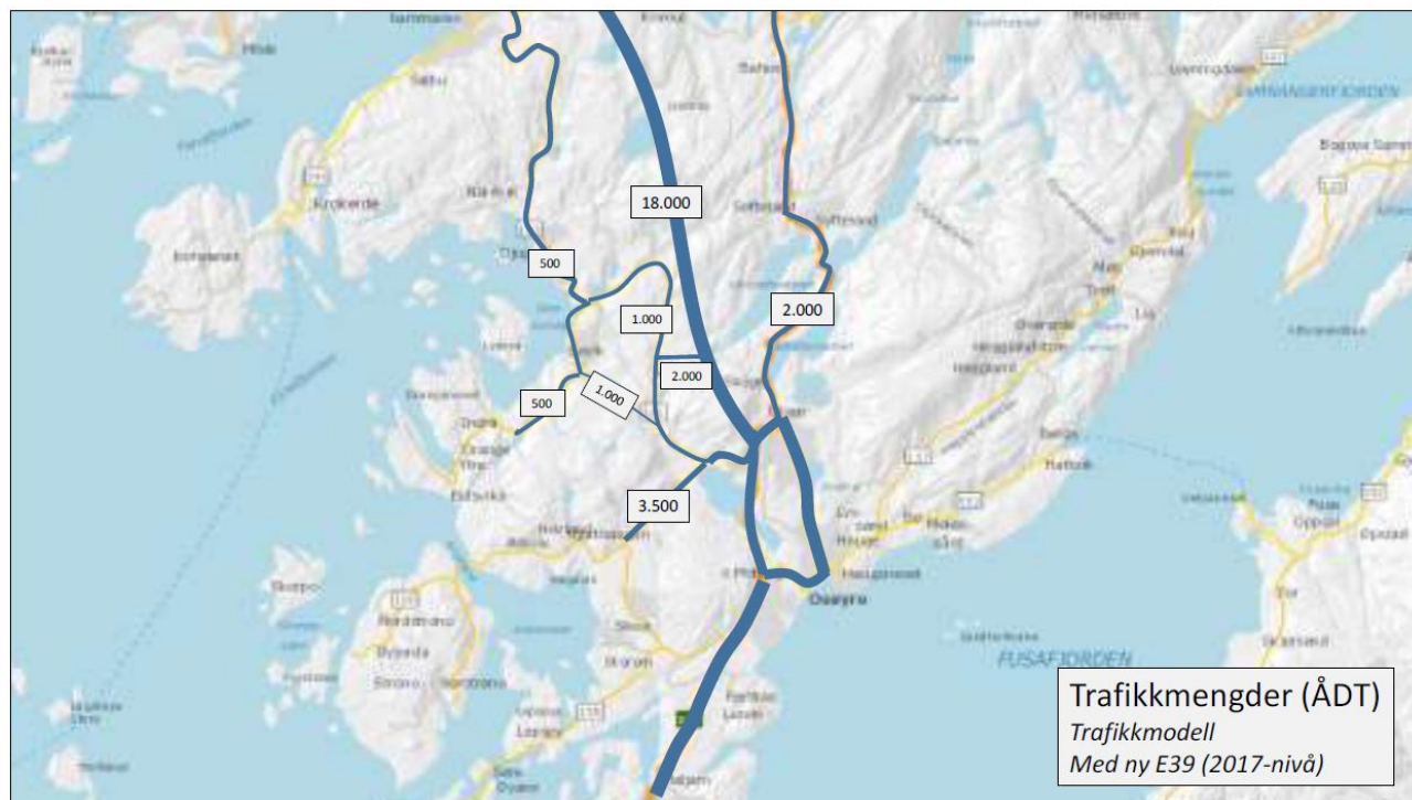
Figur 8. Framtidig forventa trafikkmengd (ÅDT) etter etablering av ny E39 parsell og fylkesveg til Helleskaret. Auke trafikk frå Lyseparken er ikkje medrekna i figuren (Sivilingeniør Helge Hopen, 2018).
